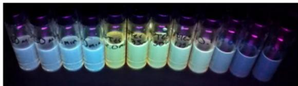
*Figura 4. Nanopartículas de silicio bajo luz ultravioleta.*
