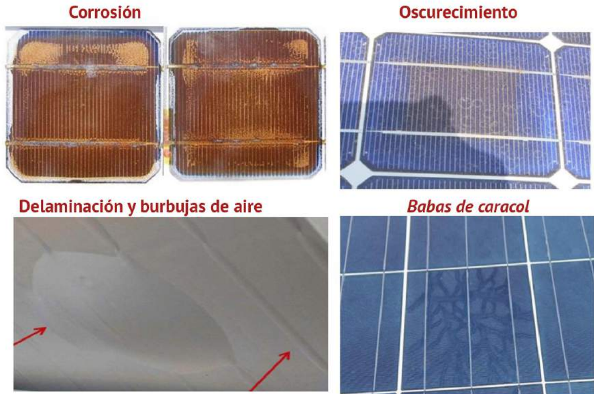
Figura 4. Fotografías de mecanismos de degradación más comunes en los MFV's.
