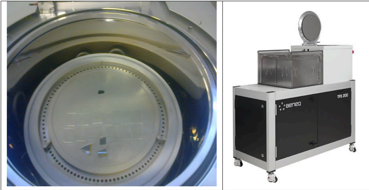
Figura 3. Esquema del reactor de ALD BENEQ.
