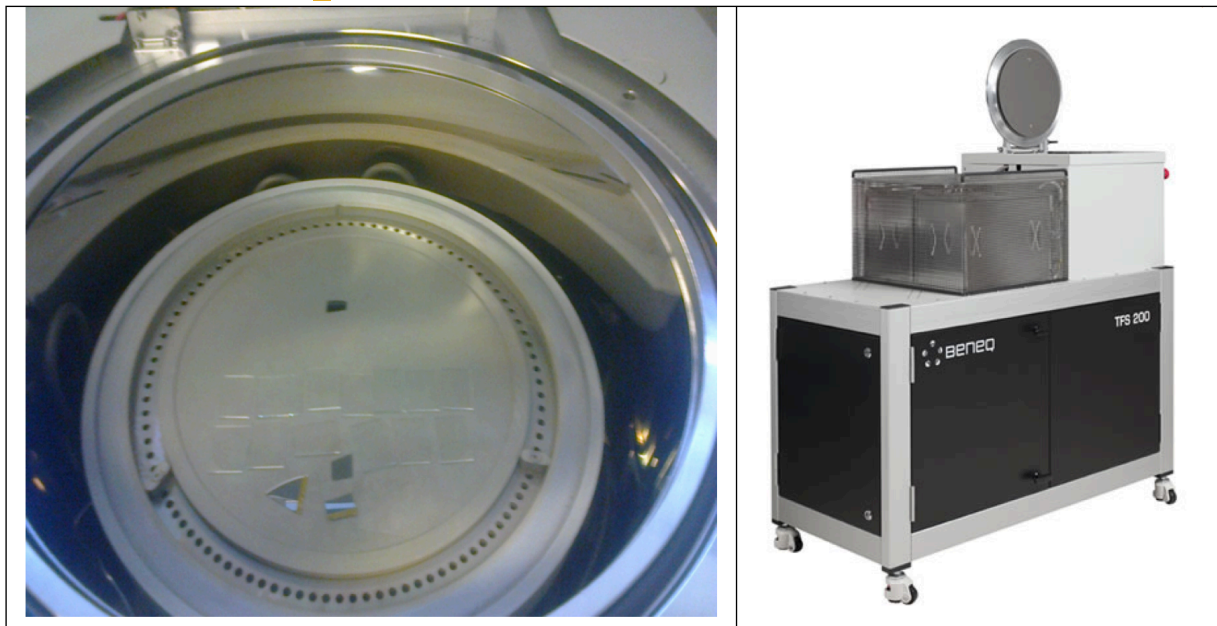
Figura 3. Esquema del reactor de ALD BENEQ.
